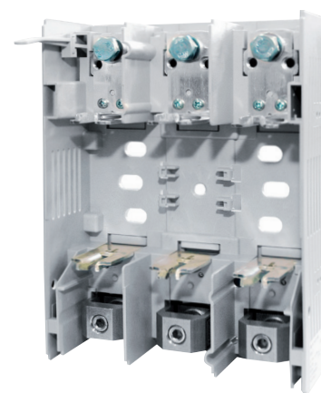
RBK 1 pro VD-M paigalduseks montaažiplaadile, pilt vinnaküliti alusplaadist ilma kaane ning klemmikatteta, ülemised klemmid - kruviklemmid, alumised klemmid - V-klemmid, (RBK 1 pro VG-M puhul on alumised klemmid - kruviklemmid, ülemised klemmid - V-klemmid)
