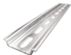
TS 35 x 7,5 Galvaniskais cinks perforētas (6,3 x 18 mm)
